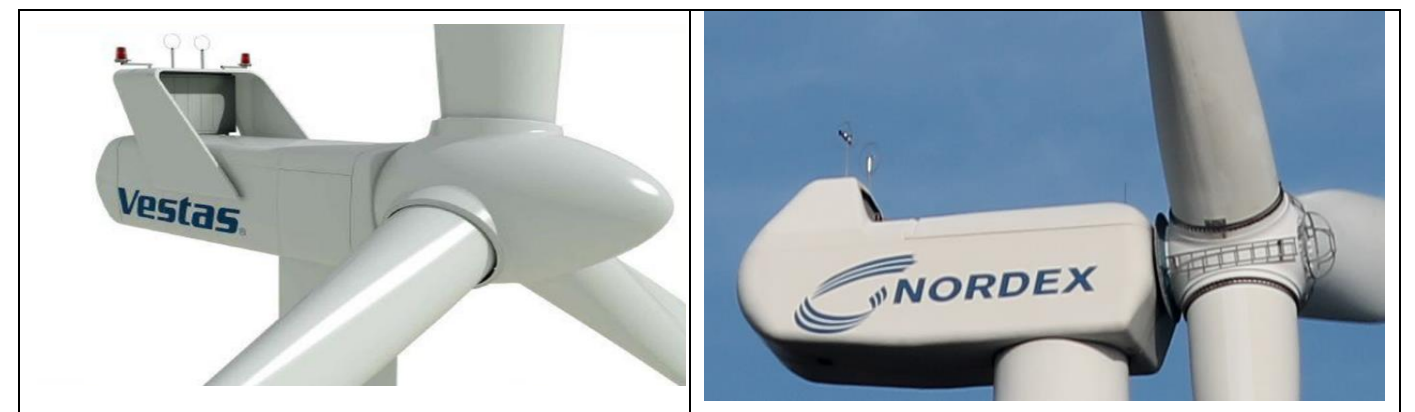
Figure 6 : Exemple de balisage sur une éolienne Vestas
